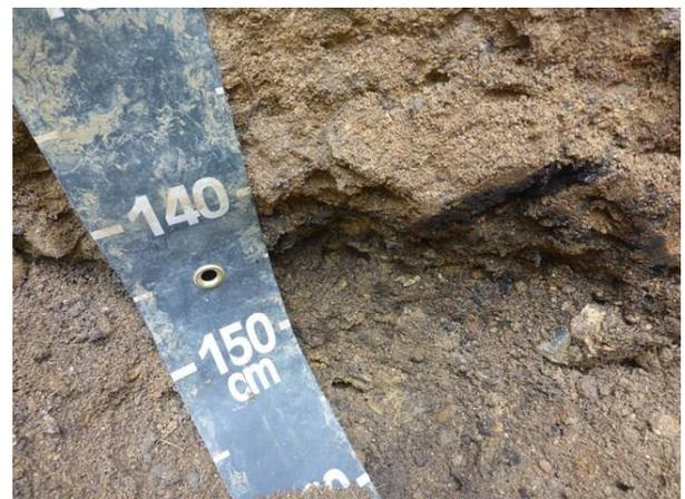
P04\_H4, apparition de l'horizon sableux en sous face de la couche de remblais
