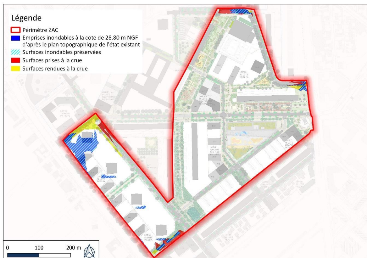
Schéma 17 : Comparaison des surfaces inondables entre l'état initial et l'état projet sur la tranche de 28.30 à 28.80 m NGF – Fond plan masse avant-projet Avril 2020
