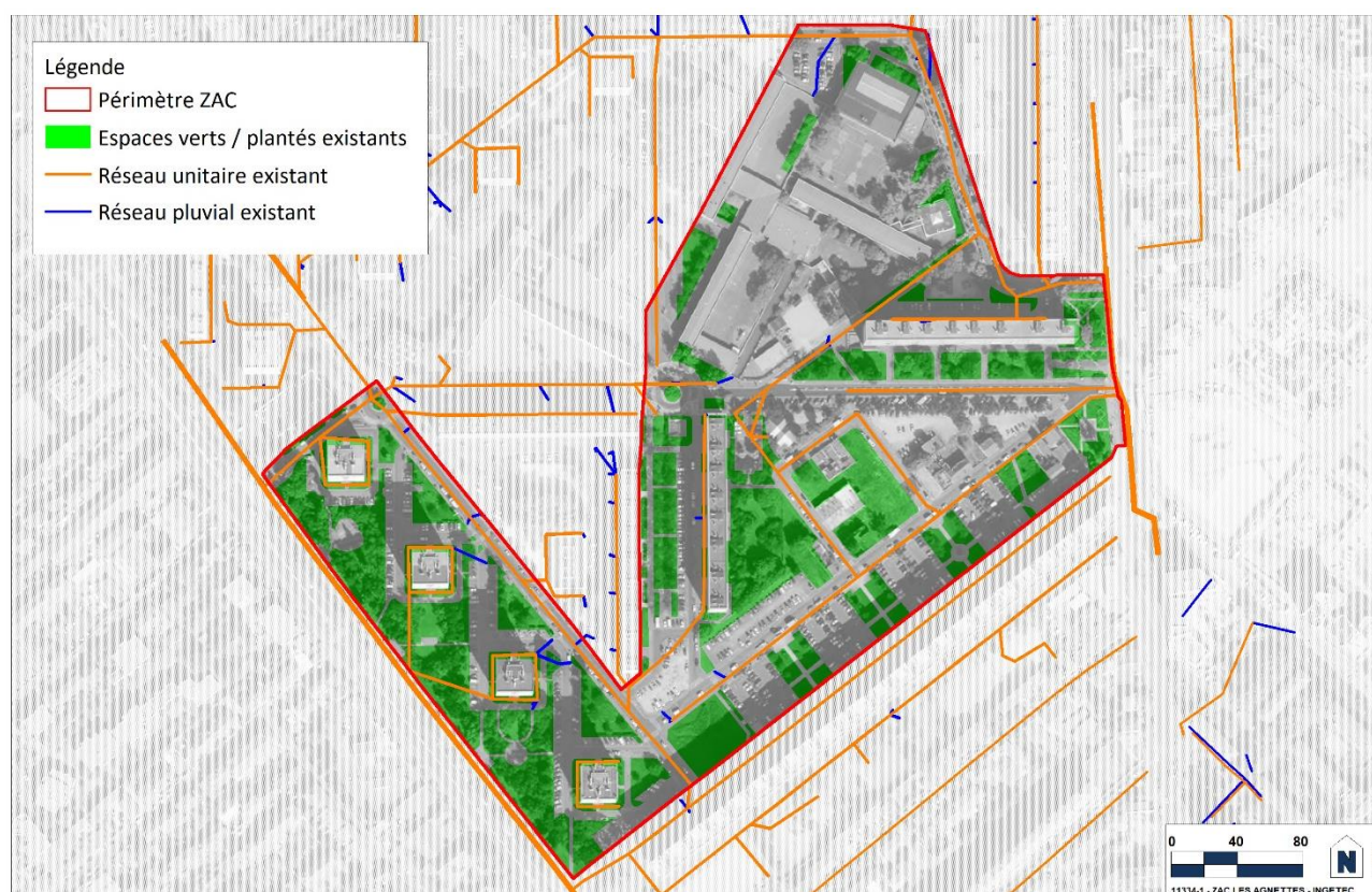
Schéma 29 : Fonctionnement hydraulique actuel au droit de la ZAC des Agnettes
