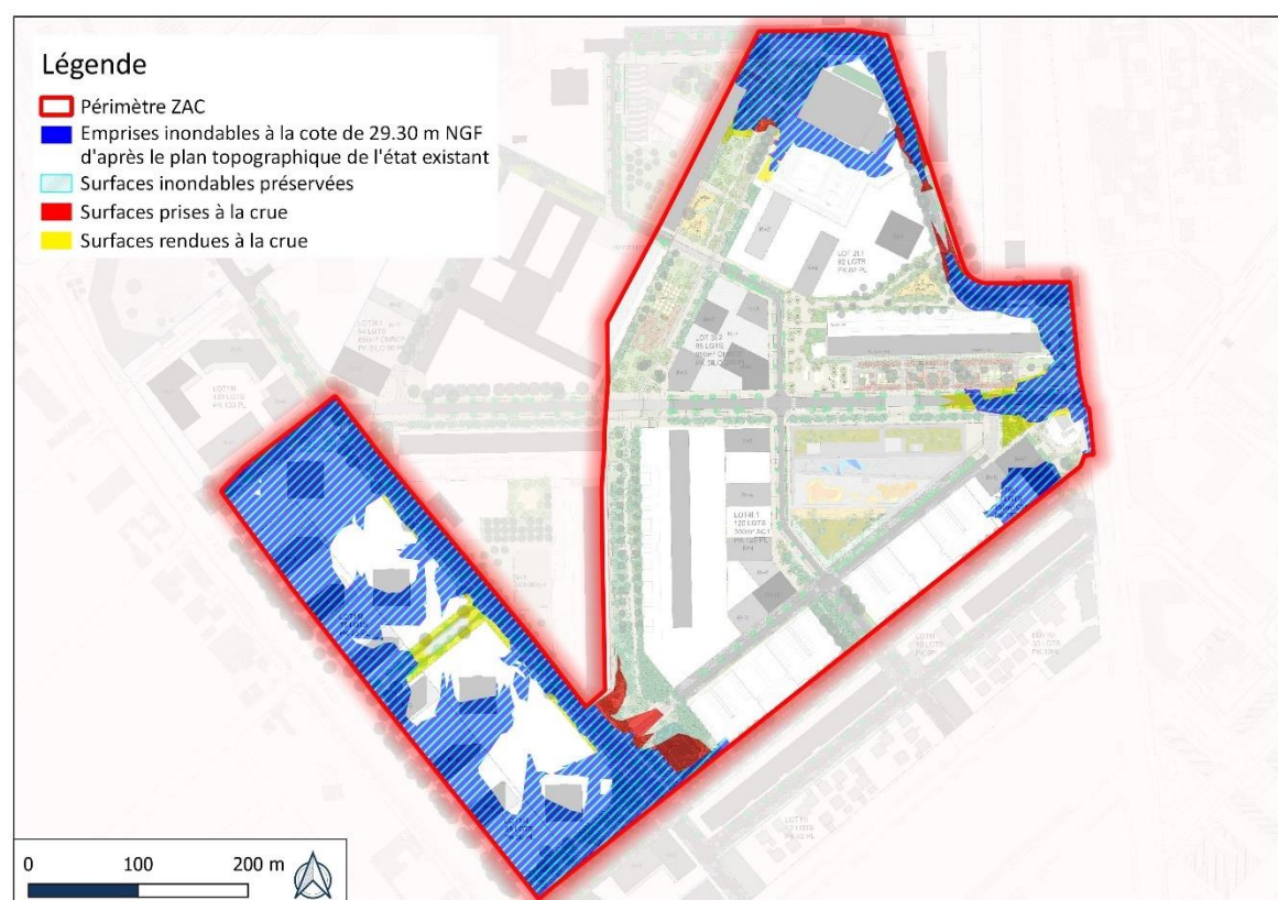
Schéma 19 : Comparaison des surfaces inondables entre l'état initial et l'état projet sur la tranche de 28.80 à 29.30 m NGF – Fond plan masse avant-projet Avril 2020
