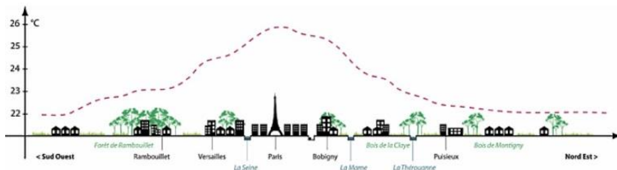
Coupe schématique de visualisation des températures en 2008 pour une nuit de canicule (type été 2003)
