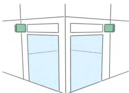
L'enseigne perpendiculaire doit être installée entre le haut des baies du rez-de-chaussée et le plancher bas du premier étage.
