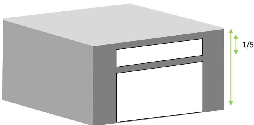
Dans le cas d'un rez-de-chaussée de faible hauteur (inférieure à 2.5 m), l'enseigne parallèle ou perpendiculaire peut s'élever, au plus haut, jusqu'à l'appui des fenêtres du premier étage.
