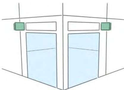
L'enseigne perpendiculaire doit être installée entre le haut des baies du rez-de-chaussée et le plancher bas du premier étage.
