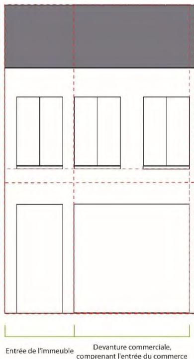
L'implantation des enseignes doit prendre en compte les lignes de composition et rythmes de façade du bâtiment, notamment la limite du rez-de-chaussée.
