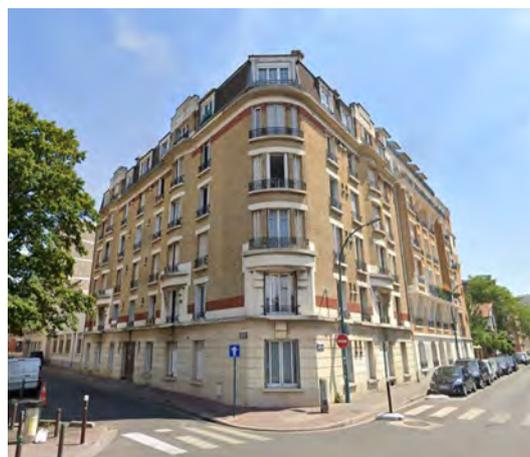
Immeuble d'angle R+4+combles parement brique, ordonnancement façade, jeu de matière avec enduit et briques. En alignement à la voirie.
